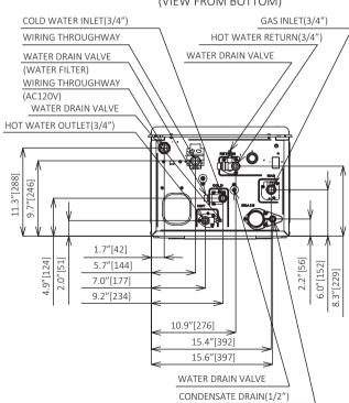
HEIGHT OF EACH FITTING FROM BOTTOM OF CASE
